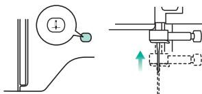
2. (針・抑え交換キー)を押して、キーとスイッチをロックする
