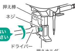
6. 刺しゅう押え<U>のネジしめ部をネジと押え棒の間に入れて、ネジをしっかりとしめる
