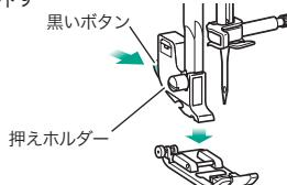
5. 押えホルダーのネジをゆるめて、押えホルダーを外す
