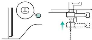
2. **⬇** (針・押え交換キー) を押して、キーとスイッチをロックする
