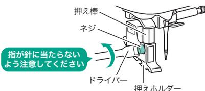
6. 刺しゅう押え<U>のネジしめ部をネジと押え棒の間に入れて、ネジを**しっかりしめる**
