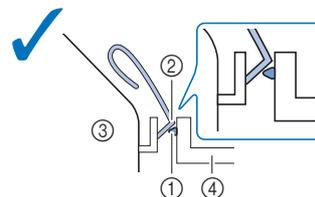
La muesca (①) no encaja firmemente debajo de la curva de la palanca (②).
