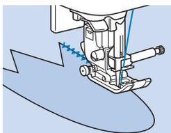
急な角度をぬうときは、アップリケ布の外側に針を刺したままミシンを止め、押えレバーを上げて少しずつ方向を変更しながらぬいます。
