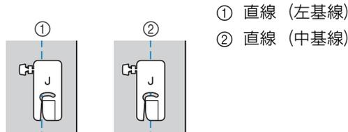
直線 (左基線) は、ジグザグの振り幅が標準の設定 (0.0mm) のときに、針位置から押えの右端まで 12mm あります。振り幅を変更 (0.0 ~ 7.0mm) すると、針位置を変更できます。押えの右端に布端を合わせてぬうと、一定の幅でぬうことができます。
