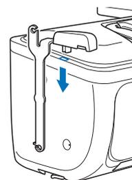
**11** Passez le fil dans le guide-fil rétractable et le guide-fil (①) à (②).
