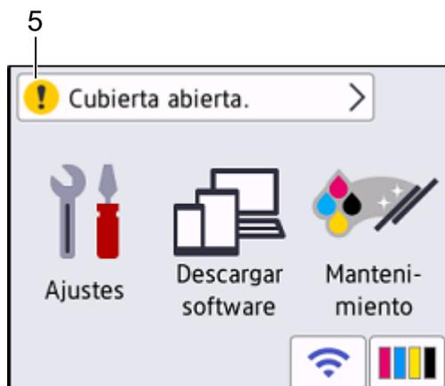
El icono de advertencia **!** aparece cuando hay un mensaje de error o de mantenimiento; pulse **!** para ver los detalles y, a continuación, pulse **X** para volver a la pantalla Inicio.
