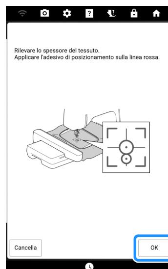
→ Il braccio dell'unità per ricamare viene spostato e l'adesivo di posizionamento ricamo fissato sul tessuto viene rilevato.
