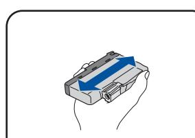
Agite rápidamente todos los cartuchos de forma horizontal 15 veces, como se muestra, antes de insertarlos en el equipo.
