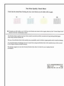
Siga as instruções exibidas na tela LCD e pressione [OK] ou ▶. O equipamento imprimirá a folha de verificação de qualidade de impressão.
