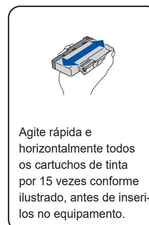
Agite rápida e horizontalmente todos os cartuchos de tinta por 15 vezes conforme ilustrado, antes de inseri-los no equipamento.
