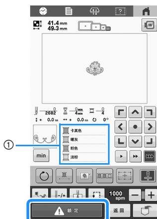
① 繡線顏色順序畫面上方為所用的繡線顏色或即將刺繡的繡線顏色。剩餘繡線顏色從上方開始按照刺繡操作先後列出。
