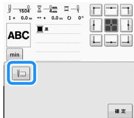
→ 將起點設在花樣左下角。移動刺繡框，使車針落點處於設定的點位。
