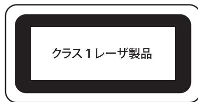
ステッチレギュレーターには、出力 0.6mW、波長 840 ~ 860nm、ビーム広がり角 1.5mrad、パルス持続時間 26us、繰返し周波数 10 kHz の目に見えないレーザを搭載し、保護筐体や回路設計によって、安全なレベルの出力に制限されています。ただし、ステッチレギュレーターを分解・改造すると、目に障がいをもたらす可能性があります。
