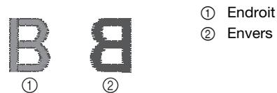
Le cas échéant, tournez la vis à tête fendue (-) dans le sens des aiguilles d'une montre de 30 à 45 degrés environ, pour augmenter la tension de la canette. Ne la serrez pas excessivement.
