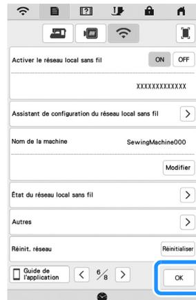
→ Le nom affiché à côté de [Nom de la machine] est le nom qui sera utilisé lors de l'enregistrement de la machine dans le logiciel de modification de broderie (PE-DESIGN Version 11 ou ultérieure) ou Design Database Transfer (Transfert de Base de données de Motifs) pour transférer des fichiers.
