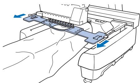
**2** Tenere il manico sulla parte inferiore del supporto tubolare per telaio e riportare il supporto tubolare per telaio esteso nella posizione originaria.
