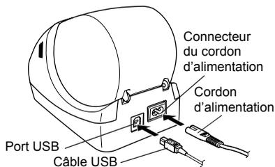
**7** Connectez le câble USB au port USB du Macintosh®. Appuyez sur le bouton Marche/Arrêt (⏻) de l'appareil pour mettre l'appareil sous tension.
