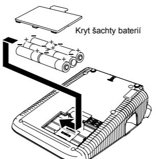
**3** Vratte na místo kryt šachty baterií tak, že vložte tři západky na jeho spodní straně do otvorů v přístroji a pak pevně zatačte na kryt tak, aby zaskočil na místě.
