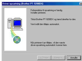
Forbind PT-9200DX til computeren ved hjælp af det medfølgende USB-interfacekabel som beskrevet på side 5, og tænd derefter PT-9200DX. En dialogboks, som viser at printerdriveren er installeret, kommer frem.
