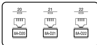
Wenn Sie den Label-Typ **Panel** verwenden, werden alle Textblöcke mit gleichem Abstand auf dem Etikett angeordnet. Diese Einstellung eignet sich daher besonders zur Beschriftung von Patch Panels, Sicherungskästen usw., deren Anschlüsse in gleichem Abstand angeordnet sind.
