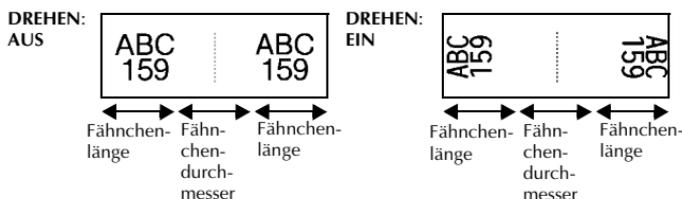
Nach Auswahl des Label-Typs **FÄHNCHEN** kann der Fähnchendurchmesser und die Fähnchenlänge festgelegt und der Text umrahmt oder gedreht werden.
