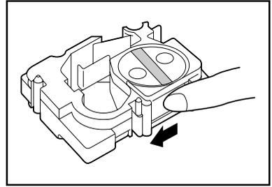
☞ Wenn nur ein kurzes Stück Band in der Kassette steckt, ziehen Sie mehr heraus, und fädeln Sie es in den Schlitz ein.
