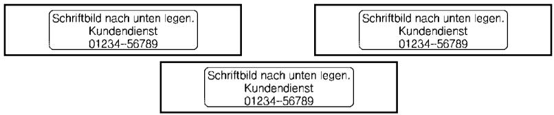
☞ *Falls der Parameter AU.SCHN in der Parametergruppe **SPEZIALDRUCK** auf AUS gestellt ist, werden die drei Etiketten zusammen gedruckt. Sie müssen diese dann entlang der gepunkteten Linie mit einer Schere abschneiden, um drei einzelne Etiketten zu erhalten.*
