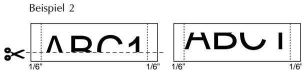
Wenn der Parameter TEILEN auf EIN gestellt ist, werden Etiketten wie oben abgebildet gedruckt. Schneiden Sie den unbedruckten Streifen unten am ersten Etikett unten und am zweiten Etikett unten ab, und setzen Sie dann die beiden Teile bündig zusammen.
