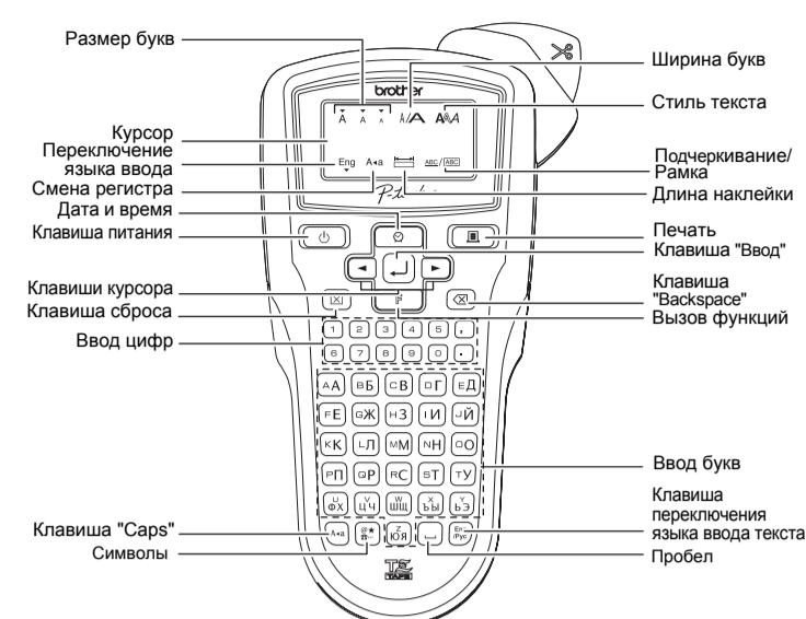
На ЖК-дисплее отображается только одна строка из 12 символов, но вводимый текст может иметь длину до 80 символов.
