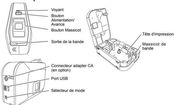
La PT-1230PC peut fonctionner de 2 modes : « EL » et « E ». Le mode par défaut utilisé avec P-touch Editor Lite est le mode EL. Pour le mode E, vous devez télécharger P-touch Editor 5,0 et les pilotes nécessaires. Pour plus d'informations sur le téléchargement de P-touch Editor 5,0, voir « Démarrage de P-touch Editor 5,0 » ci-dessous.
