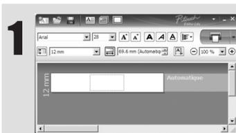
**1** Lorsque la valeur **Maximum** (valeur par défaut) est sélectionnée pour les marges, les étiquettes sont imprimées avec une marge de 1 po environ de chaque côté du texte. Réduisez cette marge en remplaçant la valeur par **Minimum**.
