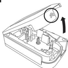
Vérifiez que l'étiqueteuse P-touch est hors tension. Ouvrez le capot comme indiqué par la flèche dans l'illustration ci-dessus tout en appuyant sur la section "<<" du couvercle.
