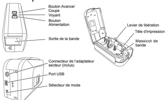
La PT-2430PC peut fonctionner dans 2 modes : "EL" et "E". Le mode par défaut utilisé avec P-touch Editor Lite est le mode EL. Pour le mode E, vous devez télécharger P-touch Editor 5.0, un logiciel de création d'étiquette plus avancé, et les pilotes nécessaires depuis le CD fourni. Pour plus d'informations sur l'installation de P-touch Editor 5.0, voir "Démarage de P-touch Editor 5.0" ci-dessous.
