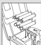
Lorsque vous utilisez l'étiqueteuse P-Touch avec les piles, placez six nouvelles piles alcalines AA (LR06) en veillant à respecter les polarités. Remplacez toujours les six piles au même moment pour les remplacer par des piles neuves.
