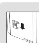
Placez le sélecteur de mode à l'arrière de l'étiqueteuse P-touch sur la position "E" avant de connecter le câble USB.
