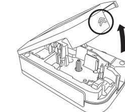
Compruebe que la rotuladora P-touch está apagada. Abra la cubierta de casete del modo indicado por la flecha de la ilustración anterior al tiempo que presiona la parte "<<".
