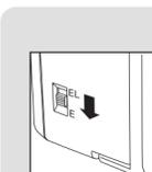
Antes de conectar el cable USB, mueva a la posición "E" el interruptor selector de modo situado en la parte trasera de la rotuladora P-touch.
