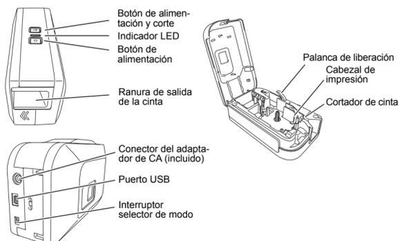
La rotuladora PT-2430PC tiene 2 ajustes de selector de modo: "EL" y "E". El interruptor selector de modo viene preconfigurado de fábrica en el modo EL, para utilizarlo con P-touch Editor Lite. Si desea ajustarlo en el modo E, deberá instalar P-touch Editor 5.0, un software de rotulación más avanzado, y los controladores necesarios desde el CD incluido. Para ver detalles sobre cómo instalar P-touch Editor 5.0, consulte "Inicio de P-touch Editor 5.0" más adelante.
