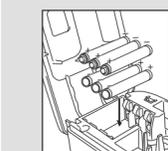
Si utiliza la rotuladora P-touch con pilas, inserte seis pilas alcalinas nuevas de tamaño AA (LR6), asegurándose de colocar los polos en la posición correcta. Cambie siempre las seis pilas a la vez y utilice pilas nuevas.
