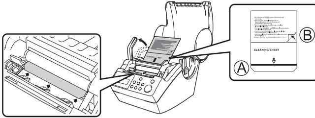
**5** Après avoir inséré la feuille de nettoyage dans l'unité d'impression, presser vers le bas le levier de dégagement du rouleau, et retirer la partie B de la feuille de nettoyage.
