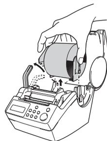
**4** Insérer le bord (A) de la feuille de nettoyage dans l'unité d'impression, et la tirer juste en face du massicot.
