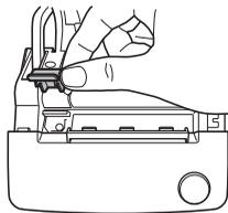
**5** À l'aide d'un tournevis à tête cruciforme, desserrer la vis qui maintient la lame du massicot en place.
