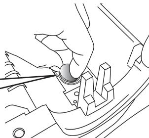
**5** Mettre en place la nouvelle batterie en respectant les polarités indiquées.
