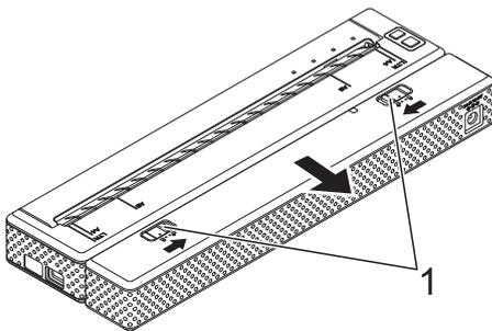
**1** Curseurs de verrouillage**Charge de la batterie Li-ion rechargeable**
