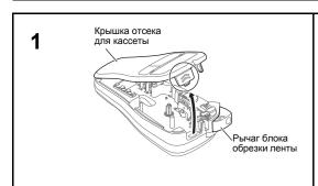
Откройте крышку отсека для кассеты, нажав на показанную на рисунке область в верхней части принтера P-touch.
