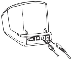
❗ 如通过 USB 集线器将打印机连接到 Macintosh，则可能无法正确检测到打印机。如果发生这种情况，请直接将打印机连接到 Macintosh 的 USB 端口。
