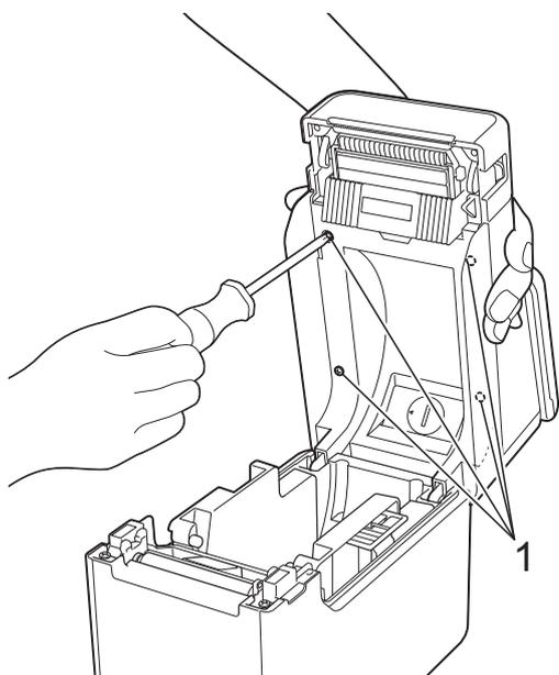
**!** Assicurarsi di utilizzare le viti fornite in dotazione con il display touch screen. Le viti installate in precedenza sulla stampante presentano una forma differente.
