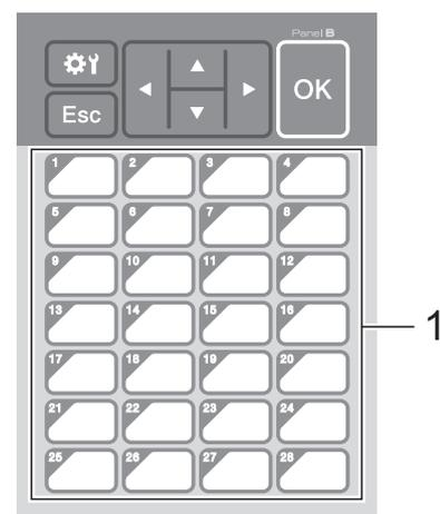
I dati registrati con i vari tasti del pannello one-touch sono determinati dal numero di tasto. Se si intende utilizzare il pannello one-touch, è necessario specificare il numero prima di trasferire i dati.
