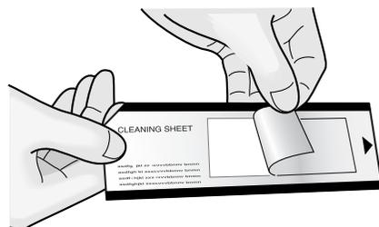
2. マガジントレイにクリーニングシートを差し込みます。マガジントレイのフロントガイドからクリーニングシートをスライドさせ、バックガイドの下に差し込みます。
