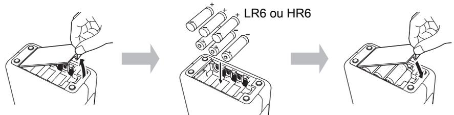
Pour retirer les piles, suivez la procédure d'installation dans l'ordre inverse.
