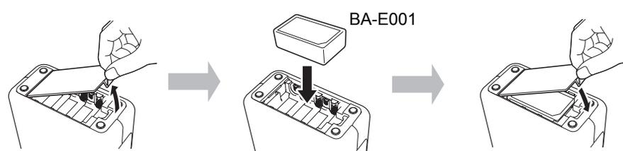
Pour retirer la batterie Li-ion rechargeable, suivez la procédure d'installation dans l'ordre inverse.
