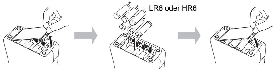
Zum Herausnehmen der Batterien gehen Sie in umgekehrter Reihenfolge wie beim Einsetzen vor.
