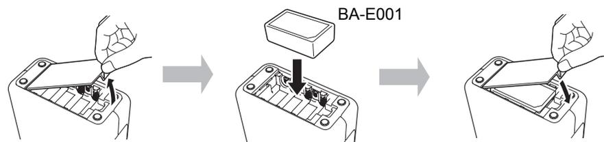
Zum Herausnehmen des Lithium-Ionen-Akkus gehen Sie in umgekehrter Reihenfolge vor wie beim Einsetzen.
