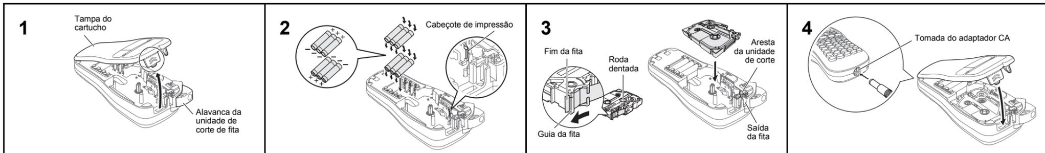
Abra a tampa do cartucho pressionando a área da parte superior do P-touch, indicada acima. Se um cartucho de fita já estiver instalado, remova-o puxando para cima. Além disso, se já houver pilhas instaladas, remova-as.
