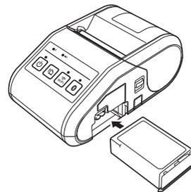
2. Con la batteria inserita e spingendola leggermente nella cavità, abbassare il dispositivo di chiusura fino a quando non scatta, bloccando in posizione la batteria.
