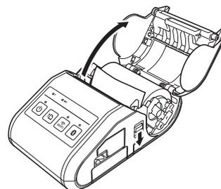
2. Spingendo la leva di rilascio del rotolo, inclinare leggermente la guida del rotolo, quindi rimuovere il rotolo. Il rotolo può essere rimosso senza cambiare la posizione della guida del rotolo. Non inclinare eccessivamente la guida del rotolo. In caso contrario, la guida del rotolo potrebbe rompersi.
