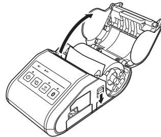
2. 在推軸釋放桿的同時，略微傾斜捲軸導軌，然後取出捲軸。不需要變更捲軸導軌的位置就可以取出捲軸。不要強制性過度傾斜捲軸導軌。否則，捲軸導軌可能會斷裂。
