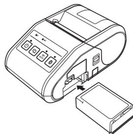
2. 插入電池後，在將電池輕輕推入電池匣中的同時，放下電池門鎖直到它發出喀啞聲，表明電池已鎖定位。
