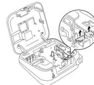
2. Instale uma nova unidade de corte. Empurre-a até que se encaixe no lugar.
