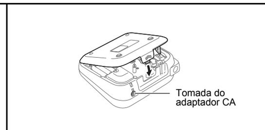
**Pressione a área da parte superior do equipamento, indicada acima, para abrir a tampa do cartucho.**
