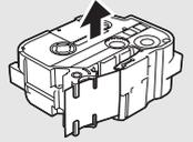
1. Controllare che l'estremità del nastro non sia piegata e che passi attraverso la guida nastro. Se non passa, farla passare attraverso l'apposita guida come indicato nell'illustrazione.
