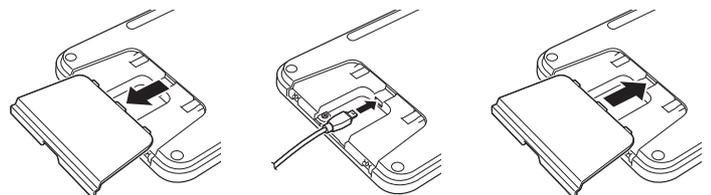
2. Collegare il cavo USB dell'unità LCD tastiera alla presa sul fianco della macchina.
