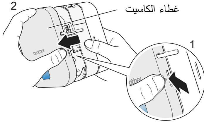
1. امسك جهازك كما هو موضح في الرسم التوضيحي. افتح غطاء الكاسيت بالضغط على العلامة الموجودة على جانبه (1) وسحبه باتجاه السهم (2).
