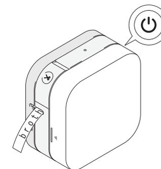
4. Corte a etiqueta com a alavanca da unidade de corte da fita. Se nem todas as etiquetas impressas tiverem sido ejetadas, prima o botão de energia duas vezes rapidamente para as ejetar.
