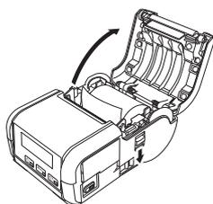
2. Spingendo la leva di rilascio del rotolo, inclinare leggermente la guida del rotolo, quindi rimuovere il rotolo. Il rotolo può essere rimosso senza cambiare la posizione della guida del rotolo. Non inclinare eccessivamente la guida del rotolo. In caso contrario, la guida del rotolo potrebbe rompersi.
