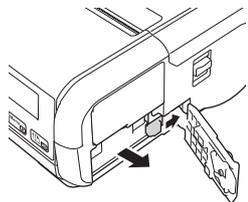
3. Chiudere il coperchio del vano batteria, quindi spostare il fermo di blocco della batteria nella posizione di blocco.
