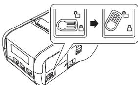
2. Spingendo il fermo di blocco della batteria, rimuovere la batteria.
