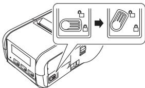
2. Inserire la batteria nel vano batteria e verificare che venga bloccata nella posizione corretta. Assicurarsi che l'estremità della batteria sia rivolta verso l'interno e orientata come illustrato. NON esercitare una pressione eccessiva nell'installare la batteria.
