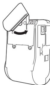
Ruotare il fermaglio nel modo visualizzato per bloccare il fermaglio per cintura.
