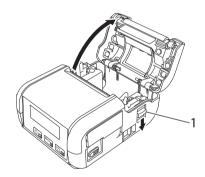
1 Фиксатор крышки
