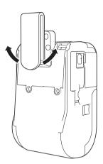
Чтобы закрепить зажим для ремня, поверните его, как Чтобы снять зажим для ремня, поверните его влево показано на рисунке.
