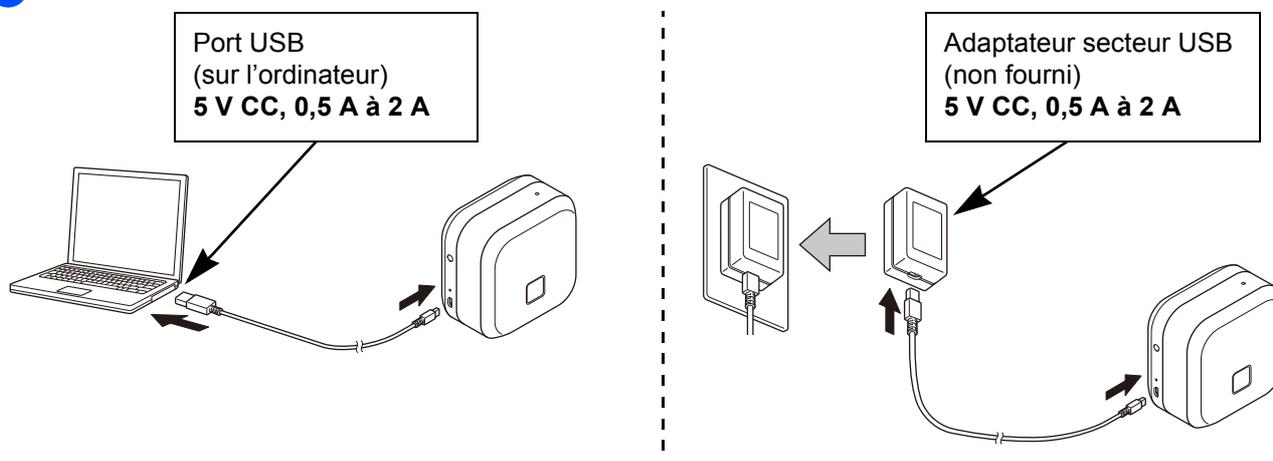
Connectez l'imprimante d'étiquettes à l'ordinateur à l'aide du câble USB fourni ou connectez le câble USB à un adaptateur secteur USB adapté au chargement d'appareils mobiles et branchez l'adaptateur à une source d'alimentation. Chargez la batterie jusqu'à ce que le voyant Batterie s'éteigne.
