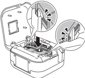
4. Appuyez sur la cassette à ruban dans l'imprimante d'étiquettes jusqu'à ce qu'elle se verrouille en place, puis fermez le couvercle.
