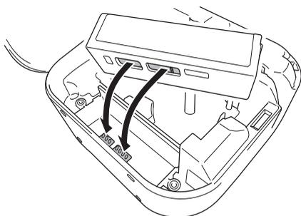
5. Lors de la réinsertion de la batterie, assurez-vous que les contacts de la batterie touchent les contacts à l'intérieur du compartiment de la batterie.
