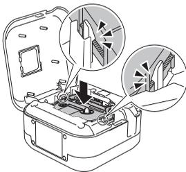
4. Presione el casete de cinta para introducirlo en la impresora de etiquetas hasta que encaje en su sitio y cierre la cubierta.
