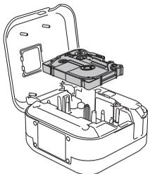
3. Inserte el casete de cinta siguiendo el dibujo que figura en el interior de la carcasa. Verifique que la punta de la cinta apunte hacia la ranura de salida de la cinta.
