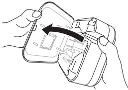
2. Abra la cubierta del casete tirando de la ranura de salida de la cinta hacia la izquierda.
