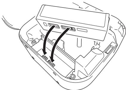
5. Al volver a insertar la batería, asegúrese de que los contactos de la batería estén tocando los contactos del interior del compartimento de la batería.
