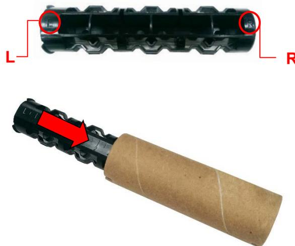
3. Insérez tout d'abord le côté droit de la tige de rembobinage du ruban (marquée « R ») dans le moyeu d'avancée du ruban. Puis, insérez le côté gauche de la tige de rembobinage du ruban dans l'orifice situé sur le côté gauche du moyeu de rembobinage du ruban.
