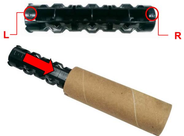
3. Primeiro, introduza o lado direito do fuso de enrolamento da fita de carbono (com a marca “R”) no eixo de alimentação da fita de carbono. Depois, introduza o lado esquerdo do fuso de enrolamento da fita de carbono no orifício situado do lado esquerdo do eixo de enrolamento da fita de carbono.
