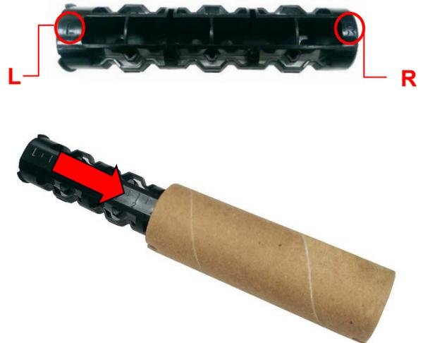
3. Setzen Sie zuerst die rechte Seite der Farbband-Rücklaufspindel (mit „R“ gekennzeichnet) in das Farbbandrad ein. Setzen Sie dann die linke Seite der Farbband-Rücklaufspindel in die Öffnung auf der anderen Seite des Farbband-Rücklauftrads ein.
