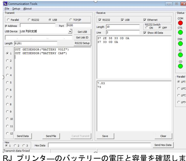
RJ プリンターのバッテリーの電圧と容量を確認します
