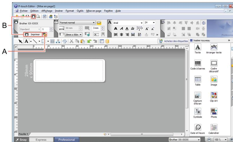
Configurez les paramètres d'impression dans la boîte de dialogue Imprimer avant de procéder à une impression. Pour imprimer, sélectionnez **Fichier > Imprimer** dans la barre de menus, ou cliquez sur l'icône **Imprimer** (A).
