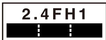
本機は 2.4GHz 帯を使用しています。変調方式として FH-SS 変調方式を採用し、与干渉距離は 10m です。
