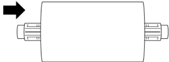
3. Instale las pestañas de fijación en ambos lados del rollo de papel.
