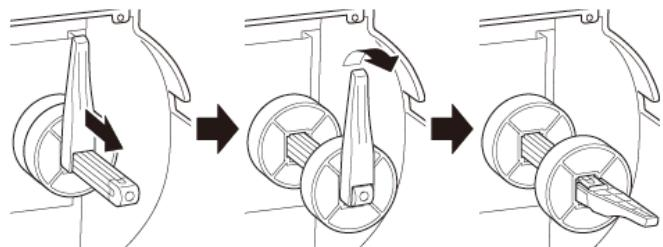
3. Anbring labelrullen på labelfremføringsspindlen, og drej derefter labelrulleafskærmningen opad for at holde den på plads.
