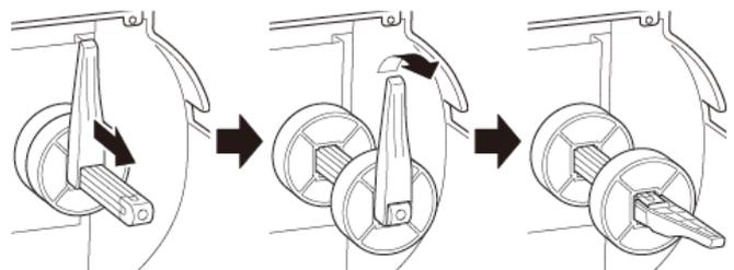
3. Coloque o rolo de etiquetas no fuso de alimentação de etiquetas e depois vire a proteção do rolo de etiquetas para cima para o manter no devido lugar.
